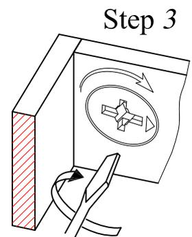
Соединение эксцентриковой стяжкой
